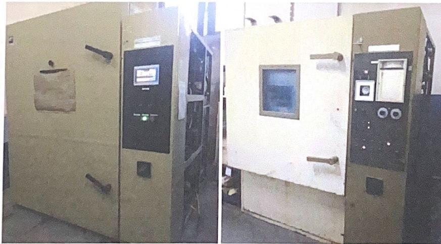
Рисунок 3 – Кліматичні камери для проведення циклічних кліматичних впливів
