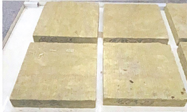
Рисунок 9 – Зволоження дослідних зразків № 16/23 теплоізоляційного матеріалу марки «ТЕХНОРУФ В ЕКСТРА»
